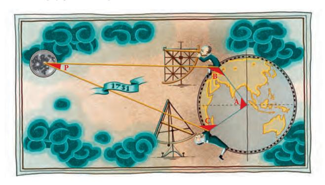
La figure et les calculs montrent les détails des mesures de Lalande et La Caille. Les angles B (126,48°) et C (145,14°) étant mesurés, et l'angle A (86°) étant connu, on sait que la somme des angles du quadrilatère ABLC vaut 360°.
